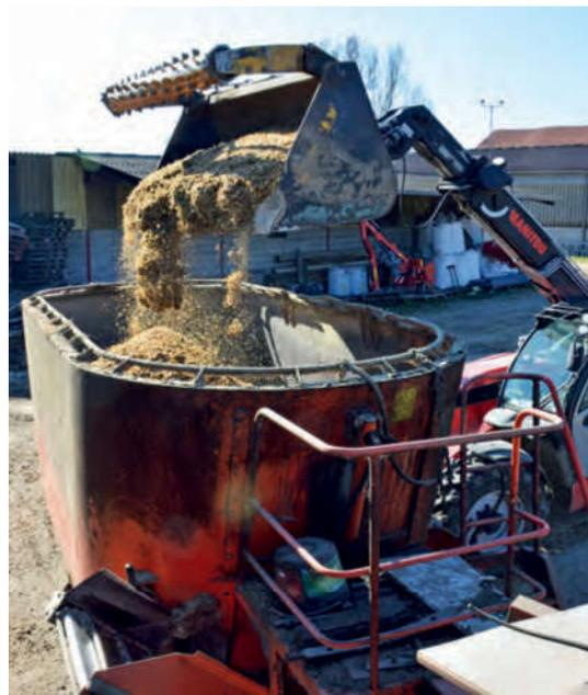
**Mélangeuse double vis de 16 m<sup>3</sup> et godet avec fraise** pour faciliter le chargement et conserver un front d'attaque propre.
