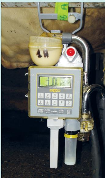
Le Lactotraite réalisé avec le Lactocorder, permet d'évaluer la technique de traite et l'efficacité du lavage de la machine à traire.
