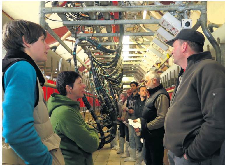
La salle de traite de l'EARL de la Houpe se compose de deux quais de 30 postes chacun, de deux aires d'attente et d'une sortie par l'avant.
