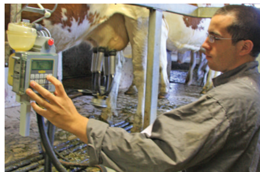
Le lactocorder, un excellent outil pour détecter les problèmes de qualité du lait liés à traite.
